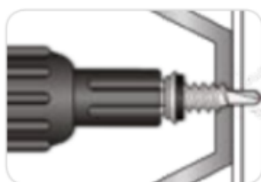
Mantenha a rotação até atravessar a telha e a estrutura.
